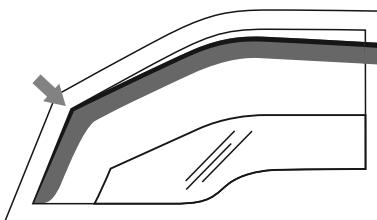
4. Desplace el deflecto hacia delante, encajando completamente el marco en el riel. Asegúrese de que el deflecto está colocado sobre el marco inferior de la ventanilla.
