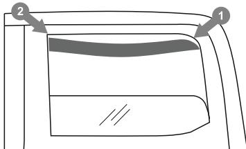
3. El deflector se debe instalar comenzando por la parte posterior. Para ello, coloque la parte posterior del marco del deflector en el riel y mueva la parte frontal hacia arriba. Coloque totalmente el marco del deflector entre los soportes de sujeción y el filo de goma, tal y como se muestra en la imagen.
