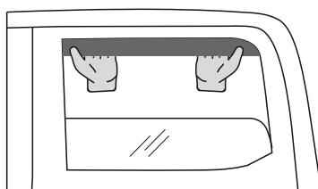
4. Inmediatamente después de instalar el deflector, ajuste la posición tirando hacia fuera con cuidado.
