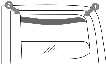
3. Le déflecteur doit être installé en commençant par l'arrière. Pour ce faire, placez la partie arrière du cadre de déflecteur dans le canal et déplacez la partie avant vers le haut. Positionner le cadre entier du déflecteur dans le canal de la fenêtre, en plaçant le cadre entre les supports de fixation et le joint en caoutchouc, comme indiqué sur l'illustration.
