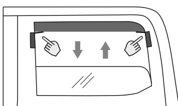
5. Placez les supports de fixation sur la partie extérieure du joint en caoutchouc, comme indiqué sur la photo. Les supports de fixation doivent toucher la partie inférieure du déflecteur.
