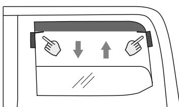
5. Coloque los soportes de sujeción en la parte exterior del filo de goma, tal y como se muestra en la imagen. Los soportes de sujeción deben estar en contacto con la parte inferior del deflector.
