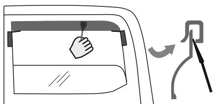
6. Pour assurer une meilleure installation du déflecteur et une meilleure adhérence entre le ruban et la surface du joint en caoutchouc, il est vivement recommandé d'utiliser la lame en plastique en la déplaçant lentement entre le joint en caoutchouc intérieur de la fenêtre et le déflecteur.
